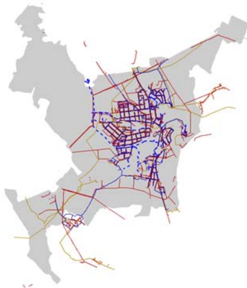
Obr. 1.2 a: Použité vrstvy technické mapy – inženýrské sítě (modr. – vodovod, přeruš. modr. – kanalizace, červ. – elektřina, okrová – plyn)
