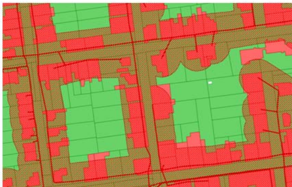
Obr. 1.4 d: Ukázka vymezení stavebních parcel s možností připojení na elektrickou síť (linie - el. vedení, šraf. plocha - zóna 20.m, červená - stav. parcely s možností připojení, bílá - bez možn. připoj., zelená - nestavební parcely )
