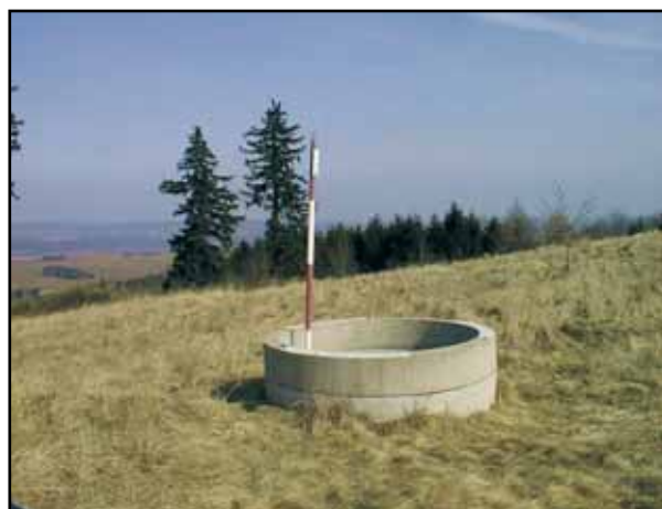
Nivelační bod. Leveling point. foto - Ivo Krčmář
